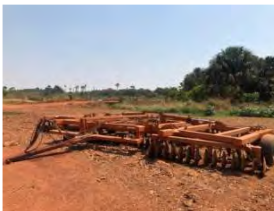
GRADE NIVELADORA CIVEMASA. GN010
