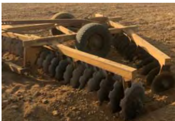
GRADE NIVELADORA. GN0006
