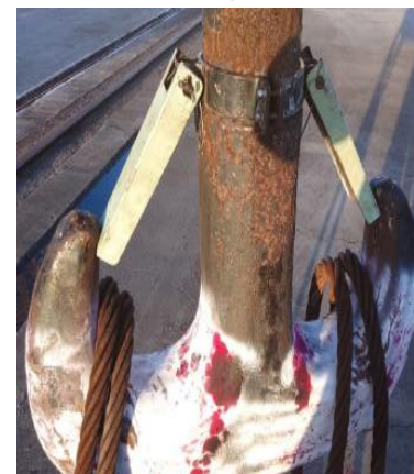
4) Substituição de trava do ZMPC e lubrificação do ZPMC 05
