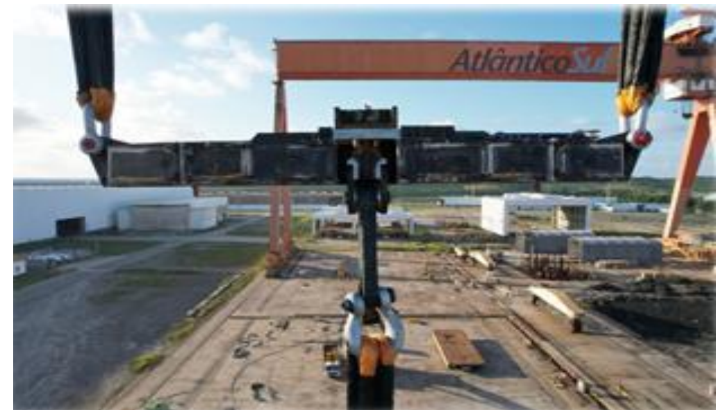
Estrutura metálica ILT BEAM - Subsea
