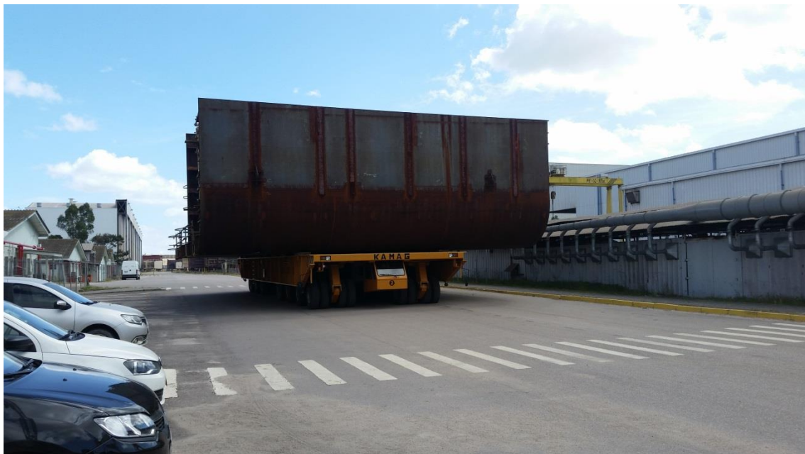
Movimentação de blocos P-72
