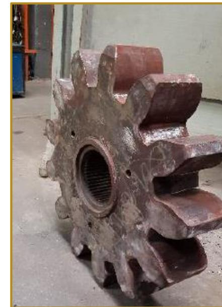
2. Vista do pinhão com o mapeamento das trincas
