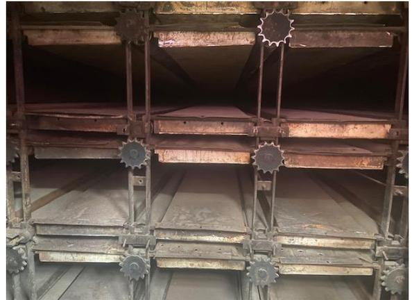
Secador de Lâminas
