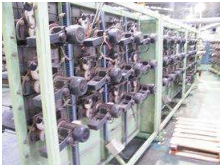
CARRETELEIRA MARCA SJ-HFJ COMPOSTA POR 196 FUSOS
