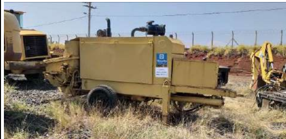
- BOMBA DE CONCRETO ESTACIONARIA -
