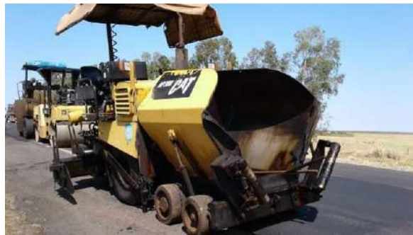
- ACABADORA DE ASFALTOS -
