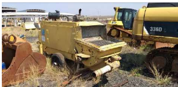
- BOMBA DE CONCRETO ESTACIONARIA -
