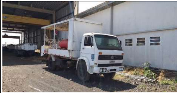
- CAMINHÃO DE COMBOIO -
