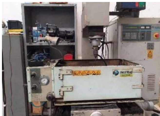
Erosão a Penetração – Engemac
