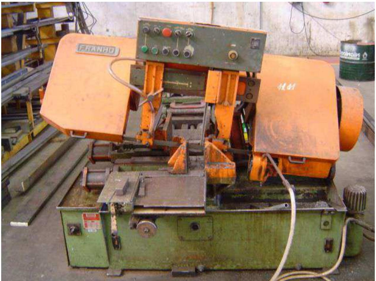
Máquina: SERRA DE FITA HIDRÁULICA SF250 A
