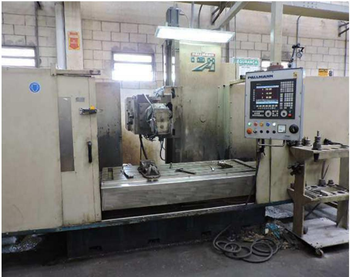
Máquina: FRESADORA FBF 20 CNC
