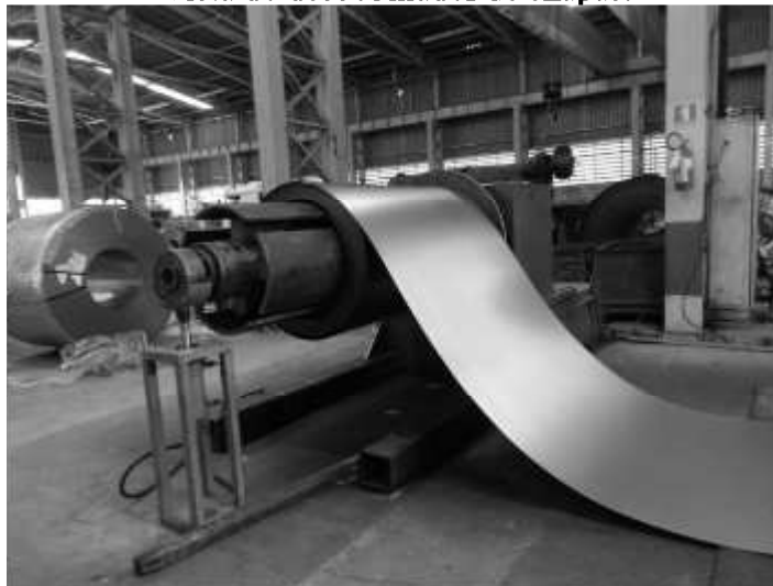
Vista do desbobinador de chapas.
