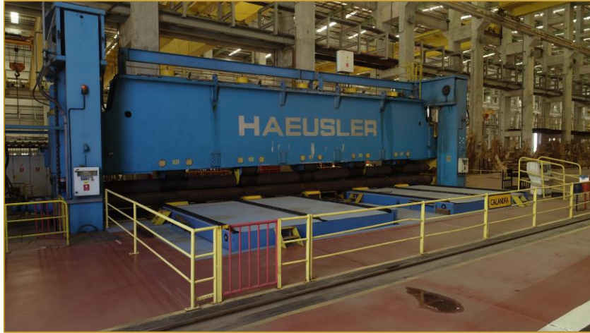
Calandra (Máquina para a curvatura de chapas)
