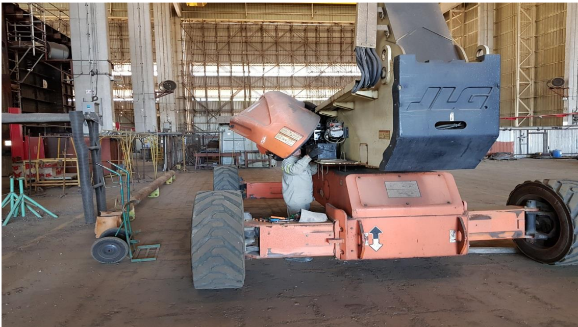
Manutenção Plataforma de Trabalho Aéreo
