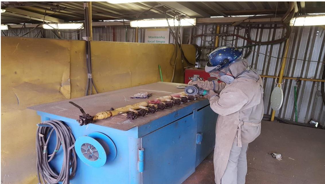
Manutenção Rede de Gases – Manifolds
