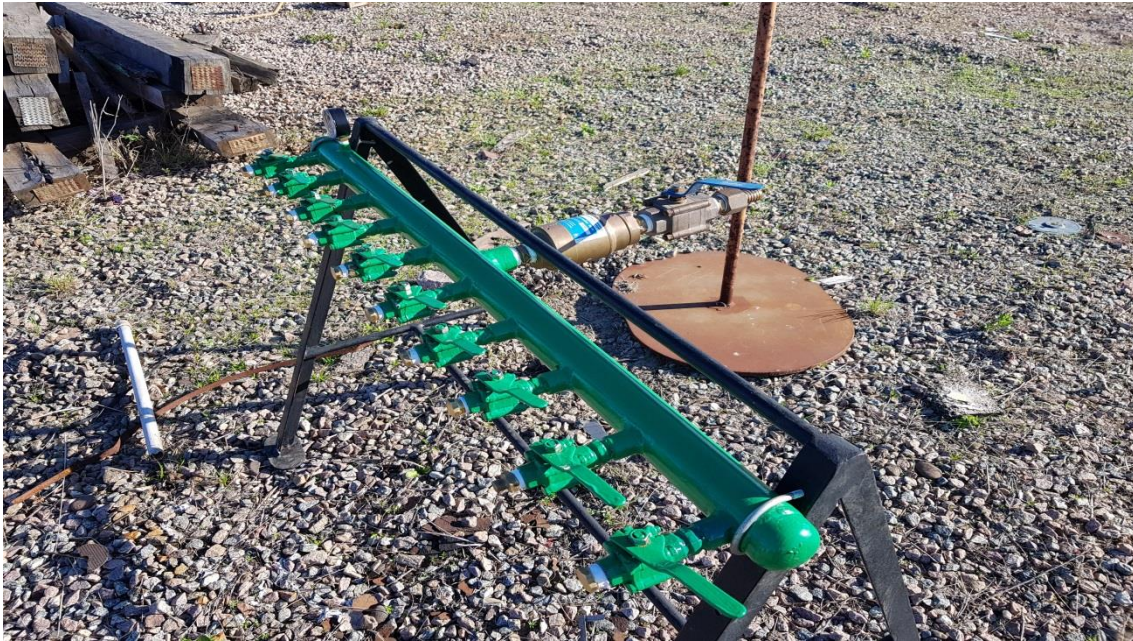
Manutenção Rede de Gases – Manifolds
