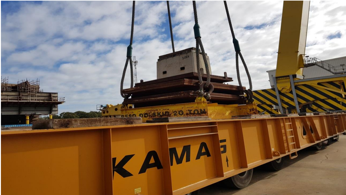
Manutenção Kamag – teste balança
