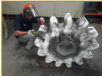
2. Vista do pinhão com o mapeamento das trincas
