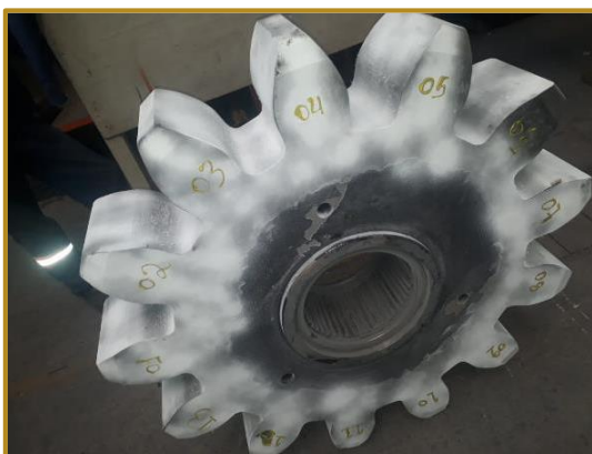
2. Vista do pinhão com o mapeamento das trincas
