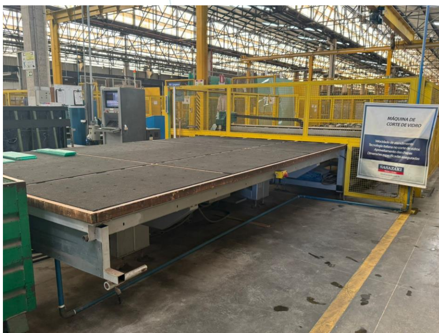
Foto 033: Máquina de cortes de vidros (continuação)
