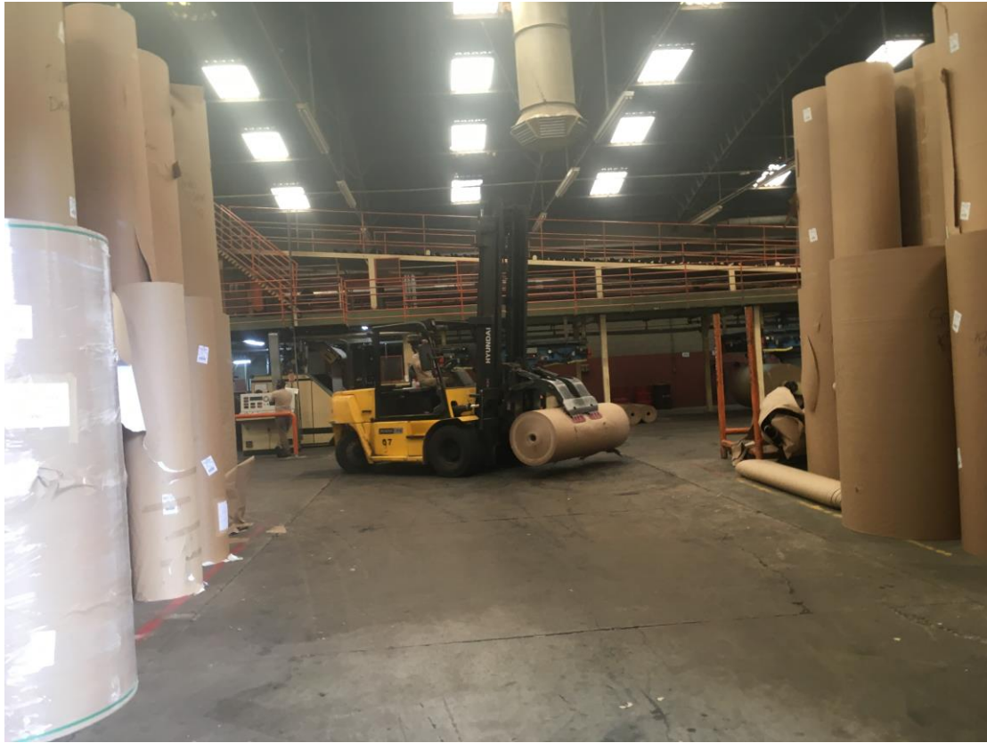
Foto 020: Empilhadeira com “garra” especial manipulando bobina de papel
