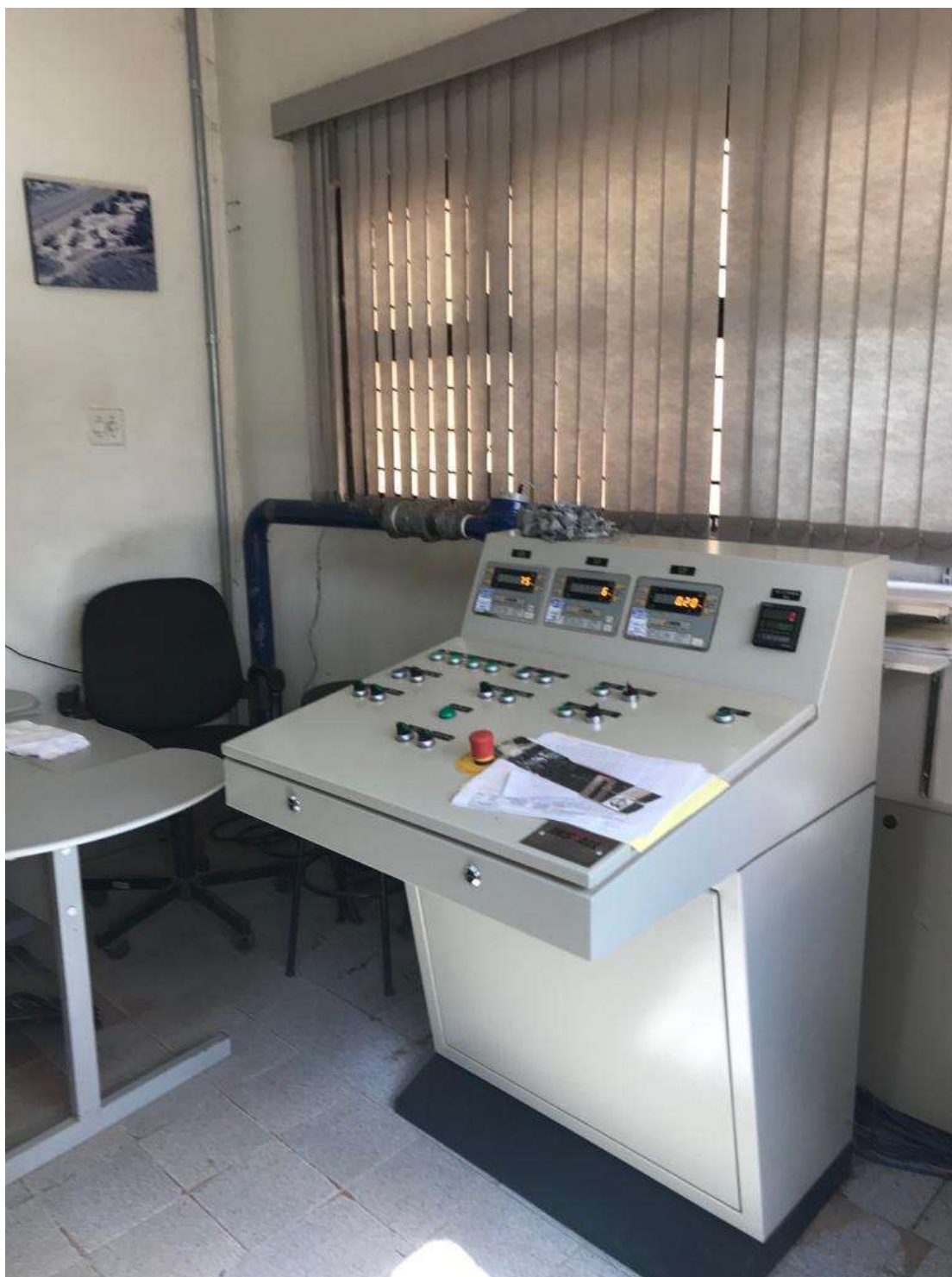
Foto 095: Controle da balança e torre de cimento
