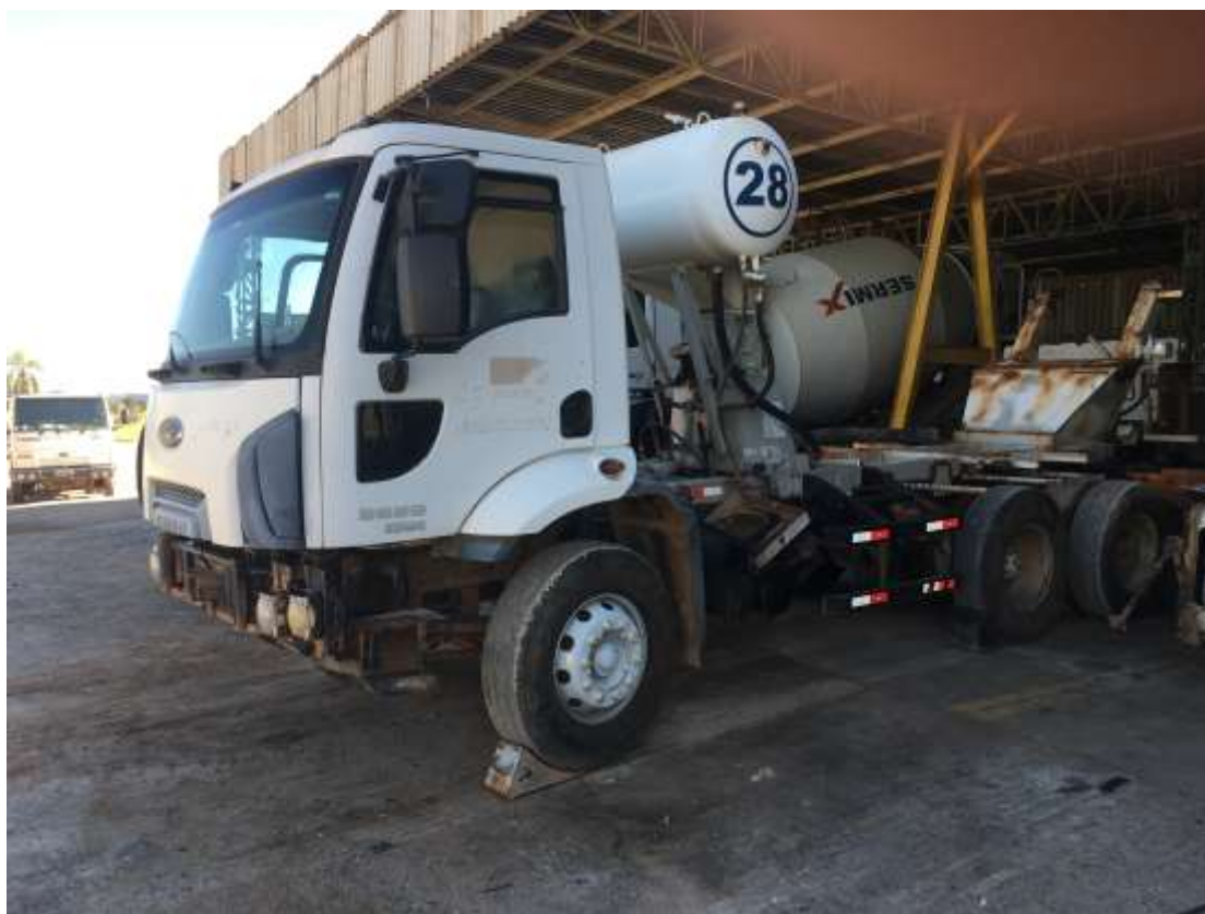
Foto 023: Betoneira parcialmente desmontada para manutenção
