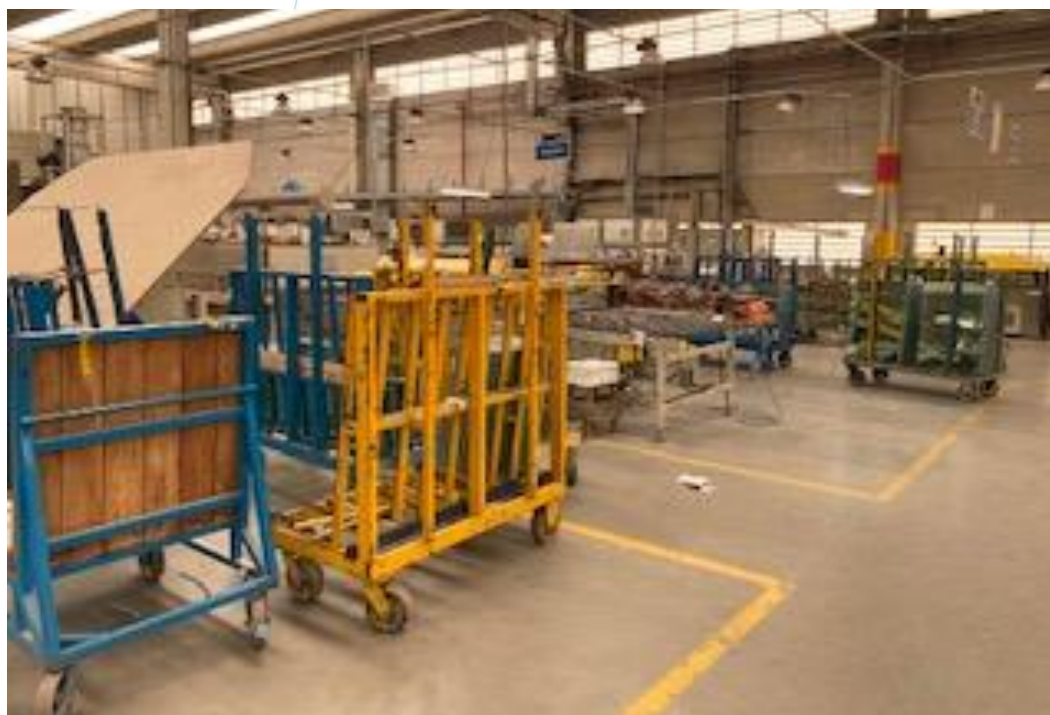
Foto 012: Alocado de vidros semiacabados ( continuação )
