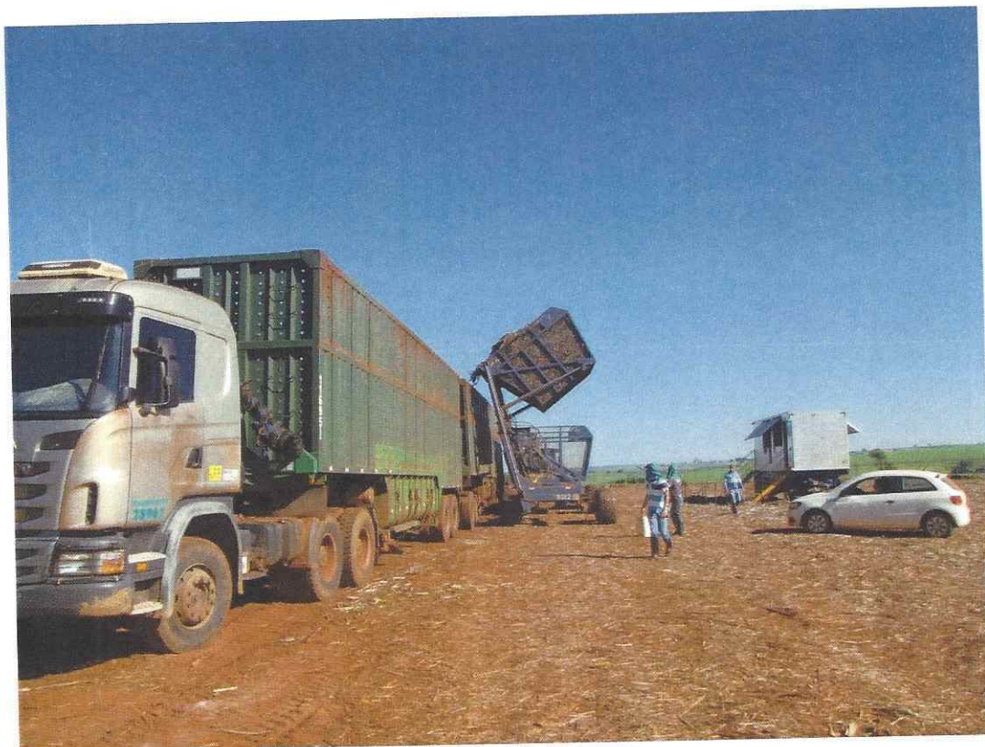
03- Transbordo carregando carreta (Bitrem)
